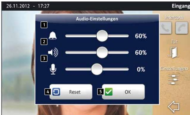
Die Glocke **1** symbolisiert die Lautstärke des Klingeltons, der Lautsprecher **2** symbolisiert die Lautstärke der im Panel integrierten Lautsprecher, das Mikrofon-Symbol **3** kennzeichnet die Einstellung der Mikrofonempfindlichkeit am Touchpanel.
