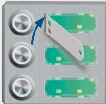
5 Das Beschriftungsfeld links anlegen und einrasten lassen, fertig.
