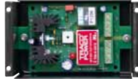
7 W Zusatzverstärker zur Verwendung für den Push-to-talk-Betrieb.
