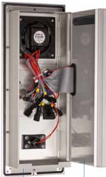
Zweikammerbauweise der Basiselektronik 20-0001
