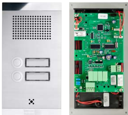
Vue de face d'un portier téléphonique série 10 et vue de l'électronique
