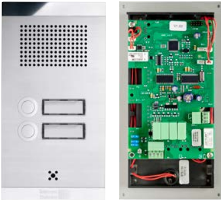
Frontansicht einer Türstation der Serie 10 und Sicht auf die Elektronik.
