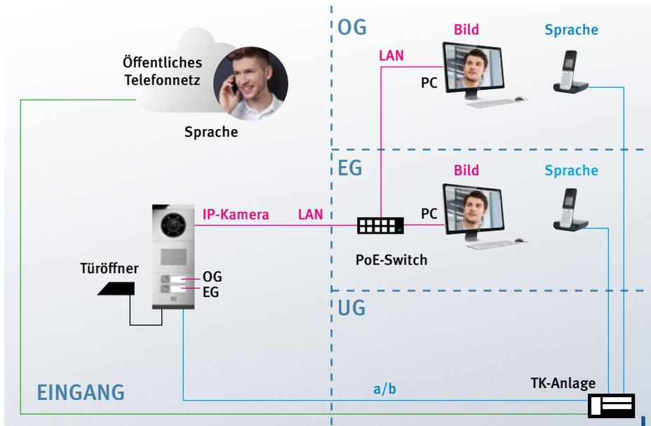
Für die Anwendungsfälle die immer noch auf einer analogen Infrastruktur basieren kann die Behnke-Station hybrid auch im a/b Modus betrieben werden.
