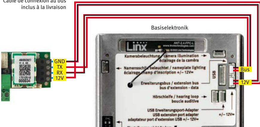
Schéma de raccordement des composants au bus SIP 3.0
