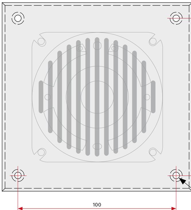
4 x Befestigungspunkte für M4 x 10 x 20 z. B. bei Säuleneinbau
