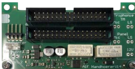
Extension électronique AIF combiné IP (comprise dans la livraison de l'électronique de base IP, commander l'électronique de base appropriée)
