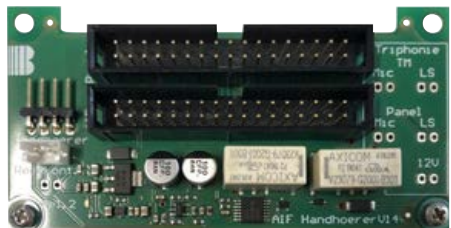
Elektronik-Erweiterung AIF Handhörer IP (im Lieferumfang der IP-Basiselektronik enthalten, passende Basiselektronik bestellen)
